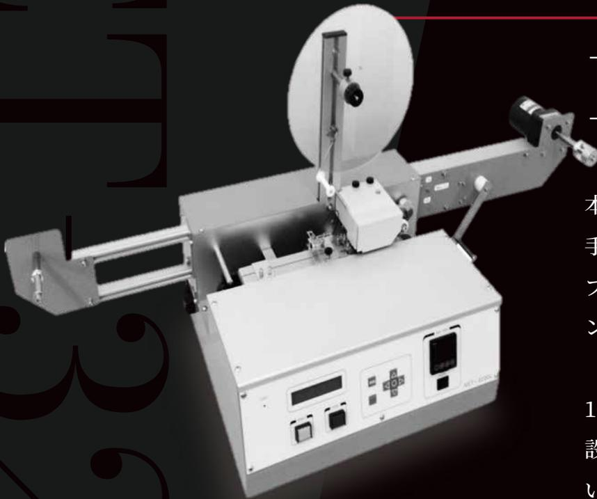
本装置はチップ部品をキャリアテープに手挿入して計数カウントし、カバーテープでシーリングし巻き取れる卓上テーピング機です。
